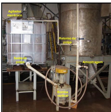
Figura 2. Montagem do sistema de homogeneização e amostragem de polpa.
