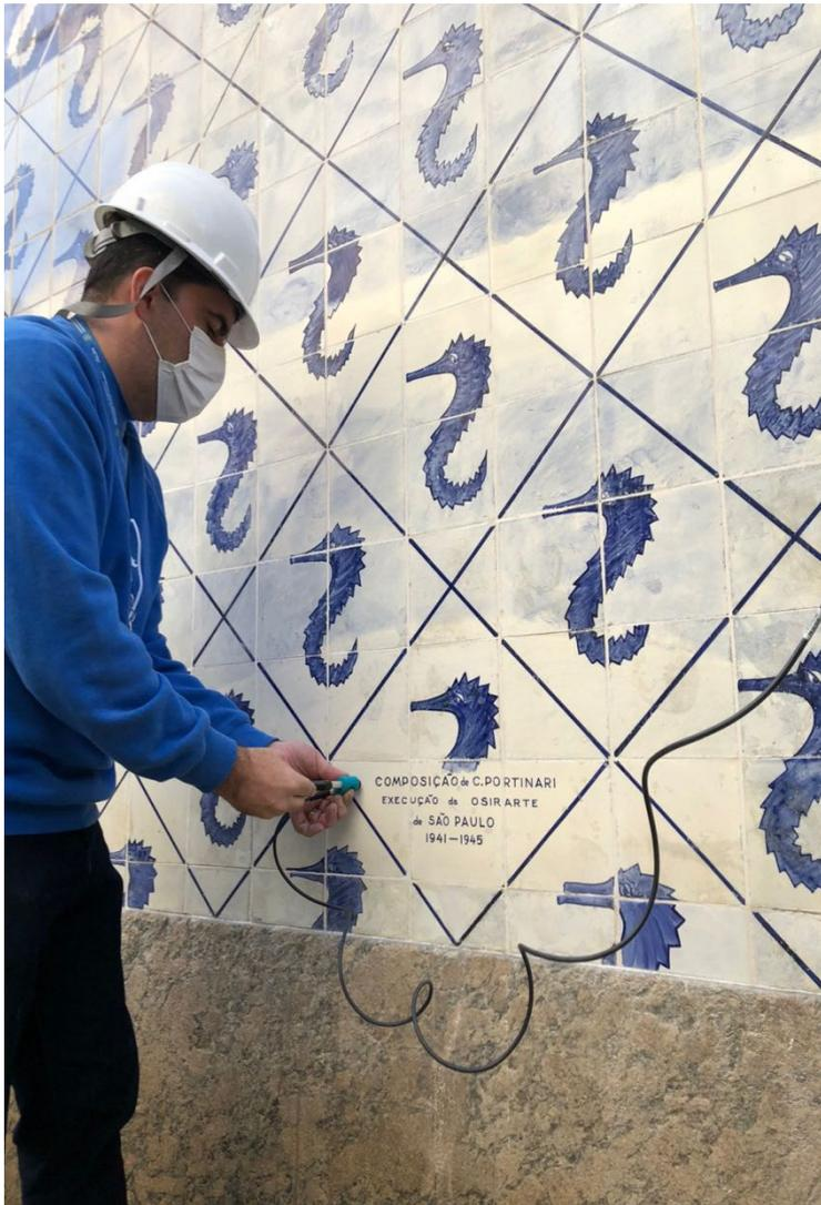
**Figura 15:** Durômetro portátil do modelo Equotip 3.
