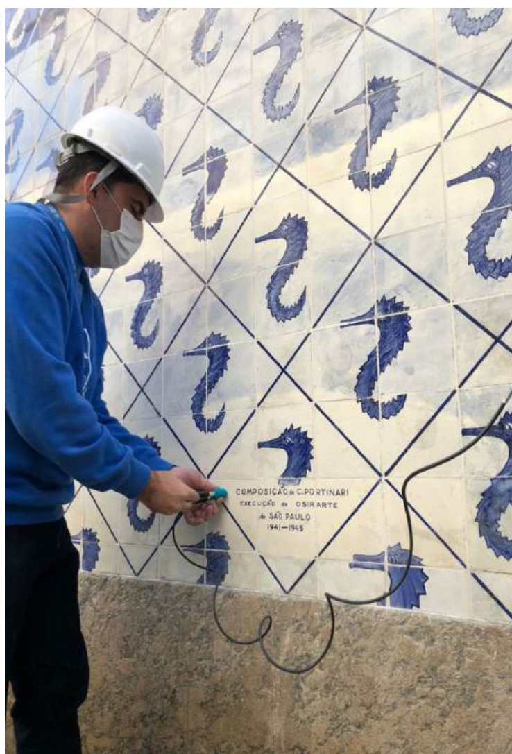
Figura 15: Durômetro portátil do modelo Equotip 3.
