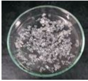
Figura 2. Microcápsulas de alginato de sódio 1,25% e cloreto de cálcio 0,5M.
