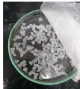
Figura 5. Microcápsulas de alginato de sódio 2% e cloreto de cálcio 1M
