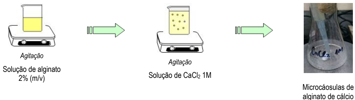
Figura 6. Esquema de formação das micropartículas de alginato via técnica de gelatinização iônica.
