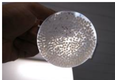
Figura 6. Microcápsulas de alginato de sódio, Cloreto de Cálcio e Cyanex 272®.
