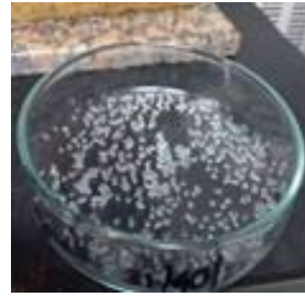
Figura 3. Microcápsulas de alginato de sódio 0,5 % e cloreto de cálcio 0,5M.
