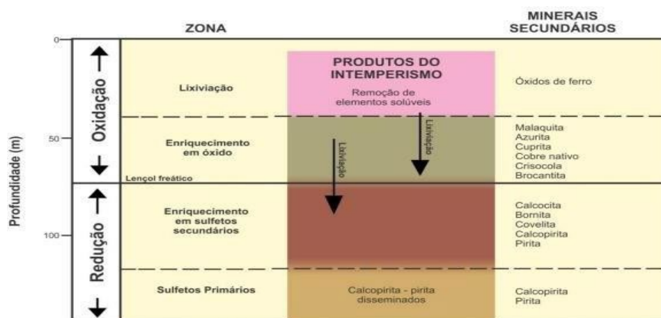
Figura 1: Ilustração representativa de um depósito de cobre com exposição à intempérie e processos de oxidação.
