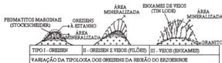
CARACTERÍSTICAS BÁSICAS DOS JAZIMENTOS DO TIPO GREISEN (MODELO GREISEN CLÁSSICO DO ERZGEBIRGE / APOORANITOS NA TERM. RUSSA) (BAUMAN, 1988)
