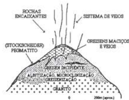
CARACTERÍSTICAS BÁSICAS DOS JAZIMENTOS DO TIPO GREISEN (MODELO GREISEN CLÁSSICO DO ERZGEBIRGE / APOORANITOS NA TERM. RUSSA) (BAUMAN, 1988)
