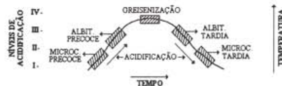
ESQUEMA DA MUDANÇA NA ACIDEZ-ALCALINIDADE DAS SOLUÇÕES NOS DEPÓSITOS GREISEN-ALBITÍCIOS
