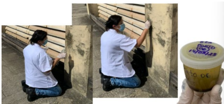
Figura 11. Procedimento de retirada da sugidade para a avaliação por ICP-Plasma.
