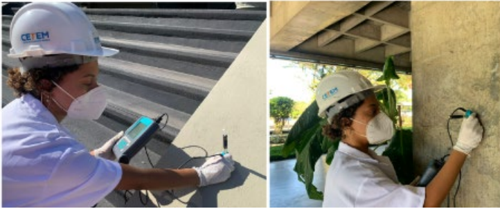
Figura 9. Ensaio de dureza com o auxílio do equipamento Equotip 550 Leeb da marca Proceq .
