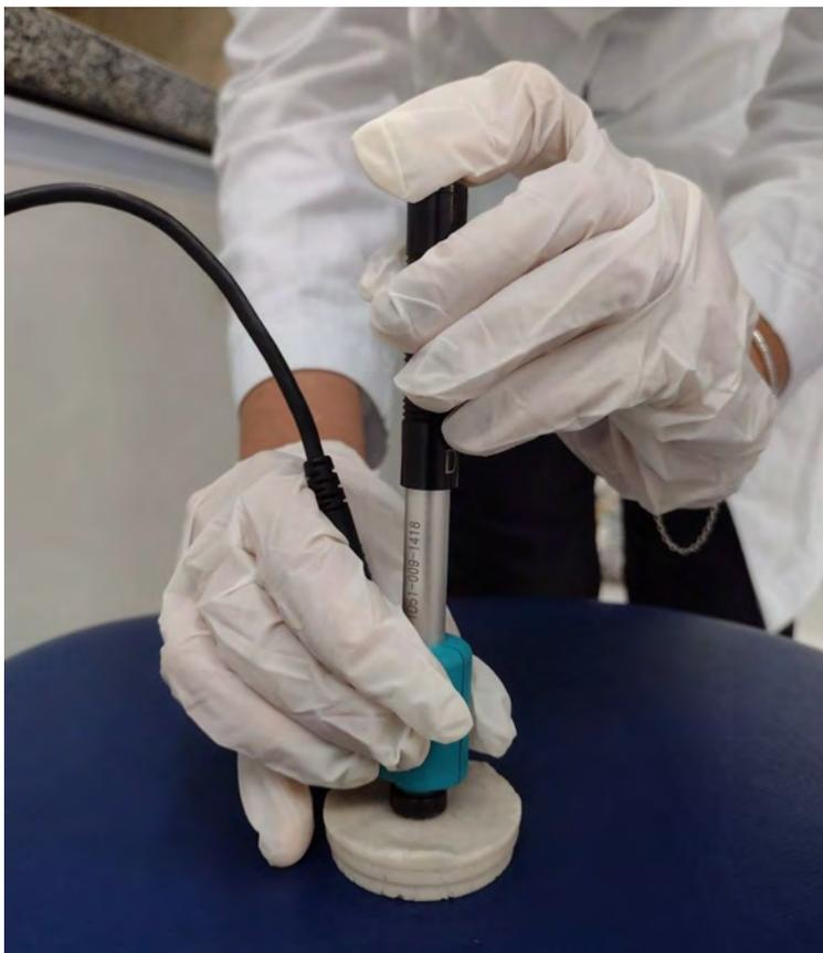
**Figura 16B.** Avaliação de dureza.
