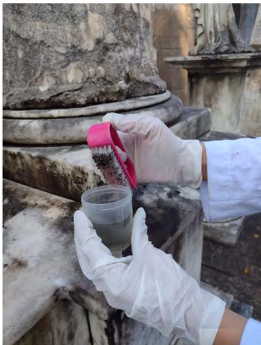
**Figura 11A.** Realização da coleta de água de lavagem.
