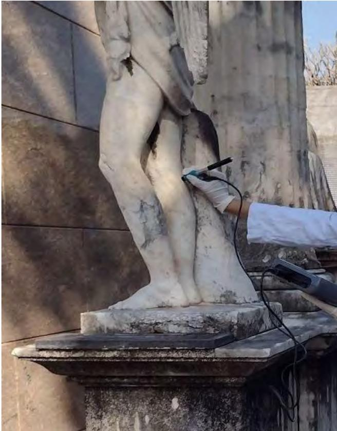
**Figura 13.** Realização de ensaio de dureza *in situ*.
