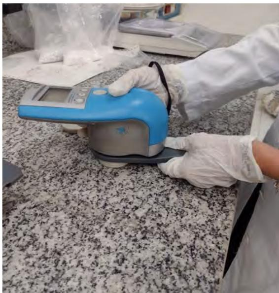
**Figura 16A.** Avaliação colorimétrica.
