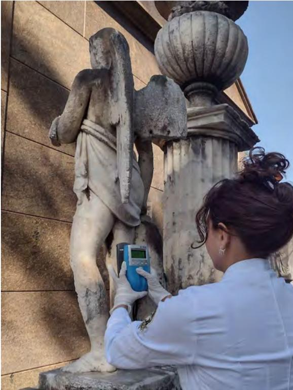
**Figura 14.** Realização de ensaio colorimétrico *in situ*.
