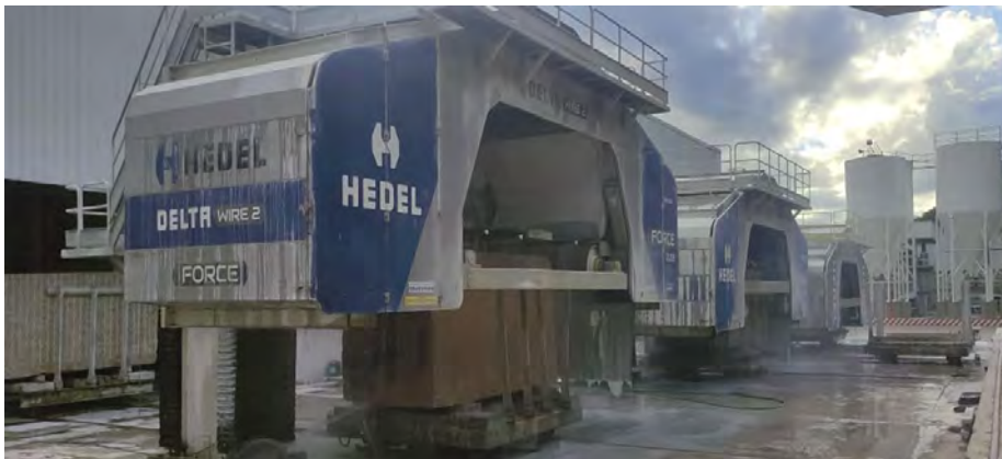
Figura 1. Exemplo de tear multifio, modelo Delta Wire 2 .
