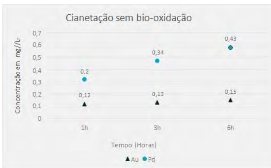
Figura 4: Extração de ouro e paládio ao longo do tempo de teste antes da bio-oxidação.
