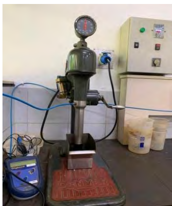
Figura 1. Máquina de flotação mecânica Denver, modelo D12 do CETEM utilizada nos ensaios de flotação.
