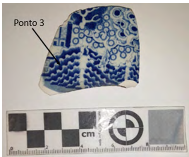
Figura 10: Ponto determinado para medição de cor e brilho na peça 3.
