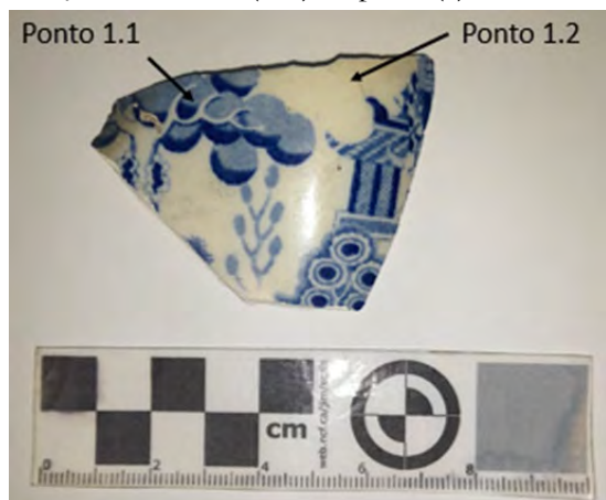
Figura 8: Pontos determinados para medição de cor e brilho na peça 1.
