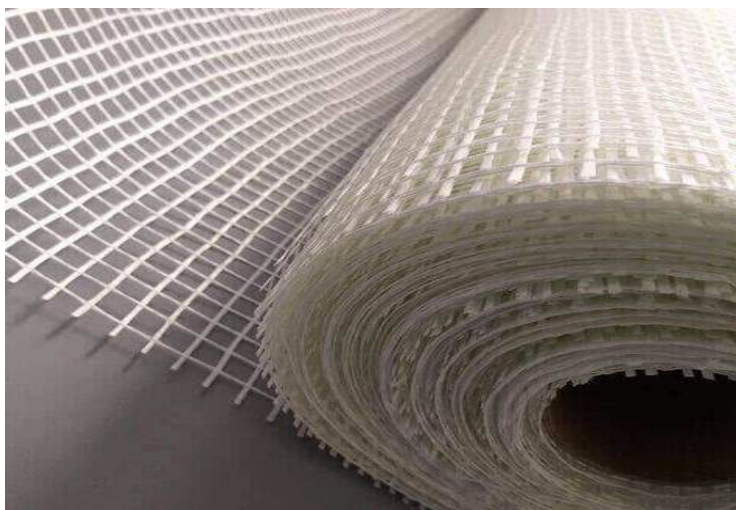
Figura 27: Tela de vidro usada no entelamento das rochas.
