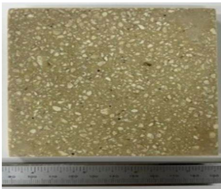
Figura 22: Corpo de prova resultado da composição 50BB1,0/25BB0,5/25BBF/10R.
