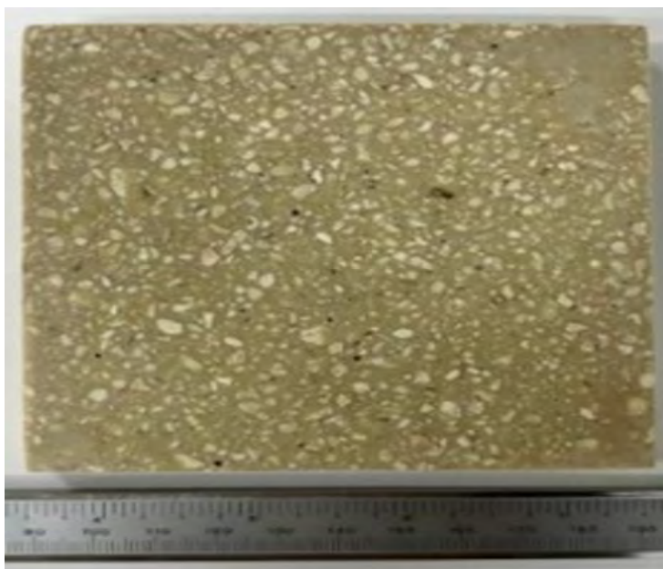
Figura 22: Corpo de prova resultado da composição 50BB1,0/25BB0,5/25BBF/10R.
