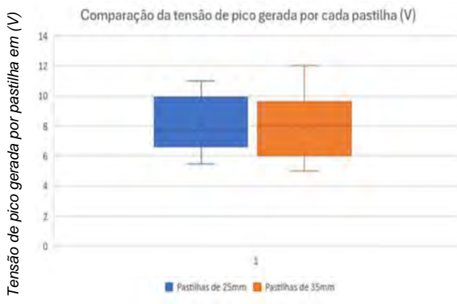
Figura 23: Box-Plot de cada pastilha após medição no osciloscópio.
