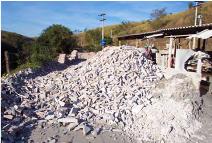
Figura 2: Resíduos grosseiros gerados nas serrarias.
