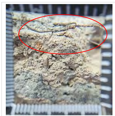
Figura 31. Avaliação em lupa do emboço do ponto 3 com a presença de tela metálica.
