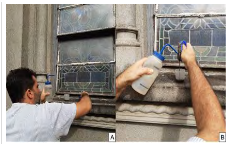
Figura 14. (A) Procedimento de coleta de sais e sujidades, (B) sujidade.
