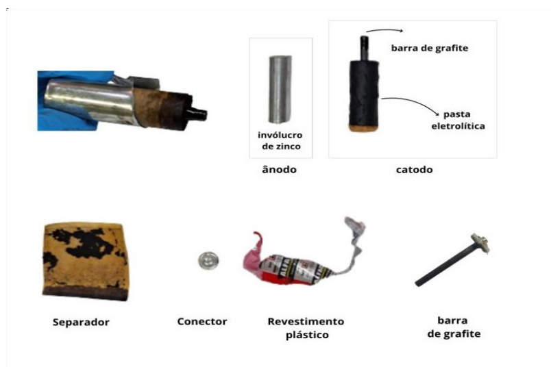
Figura 1: Componentes da pilha ALFACELL
