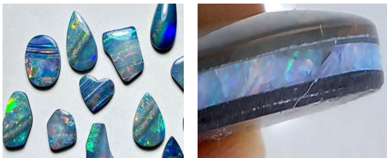
Figura 18. A esquerda, doublets de opalas, tendo como base, uma placa de diabásio (Tamanhos: 12,0 a 18,0 mm). A direita, detalhe de um triplet formado por uma base de diabásio, camada central de opala e topo de vidro. Espessura: 6,0 mm.
