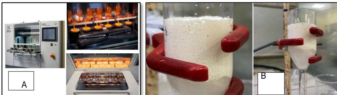
Figura 1. FORJ, instrumento utilizado para realizar a fusão (A); Coluna de resina IRA743 com lã de vidro ao fundo da coluna (B).
