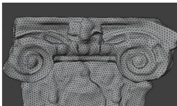
Figura 2: Malha Isométrica formada por polígonos e vértices.
