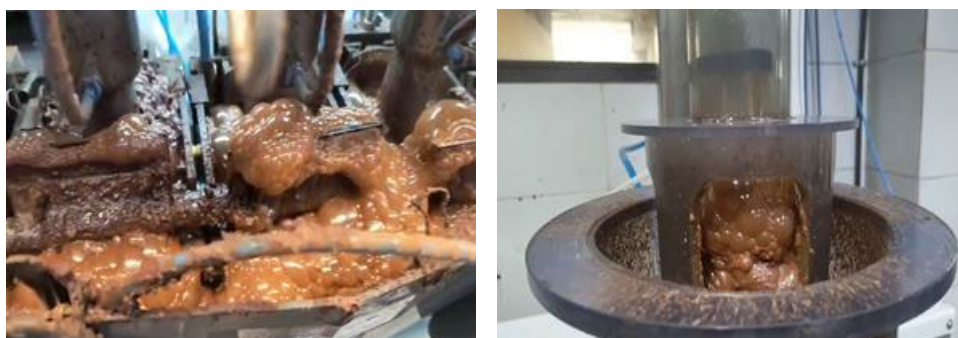
Figura 1: Imagens da espuma de flotação nas etapas rougher e cleaner .
