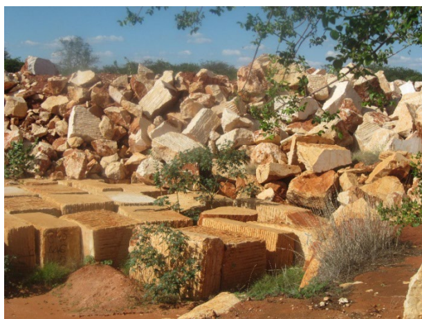
Figura 1: Resíduos gerados na lavra e no beneficiamento do Mármore Bege Bahia.
