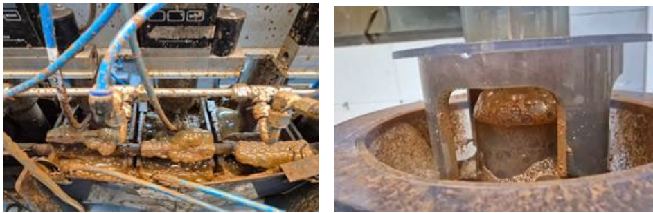
Figura 2: Imagens da espuma de flotação nas etapas rougher e cleaner .
