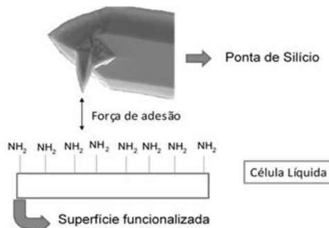
Figura 1: Representação esquemática da medida de força de adesão entre a ponta de silício, com camada nativa de SiO 2 , e o wafer de nitreto de silício funcionalizado com grupos amina.
