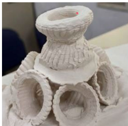
Figura 8: Coral gerado em impressora 3D.
