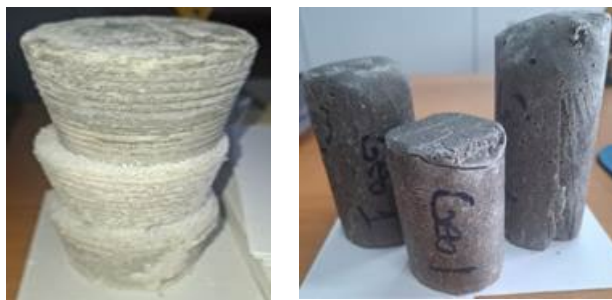
Figura 1: Comparação do geopolímero (com selamento X sem selamento após 28 dias).
