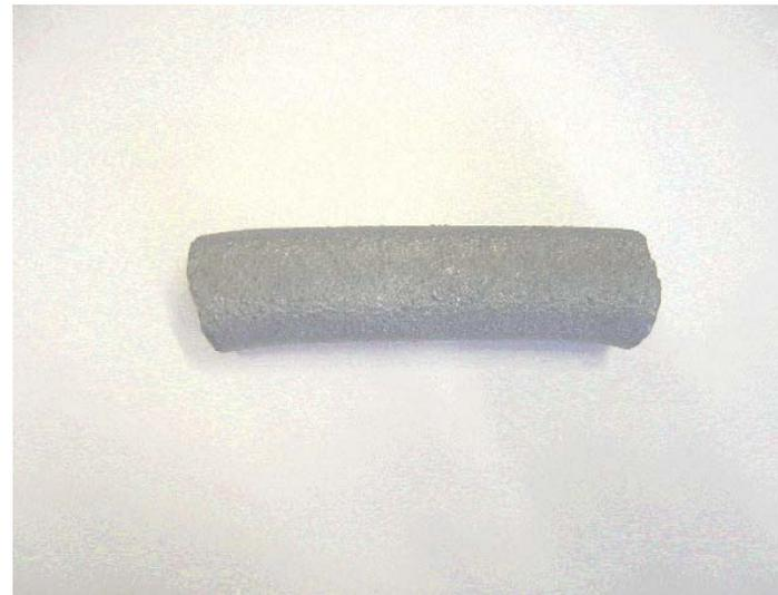
Figura 2. Silício policristalino do reator em U <sup>(8)</sup>
