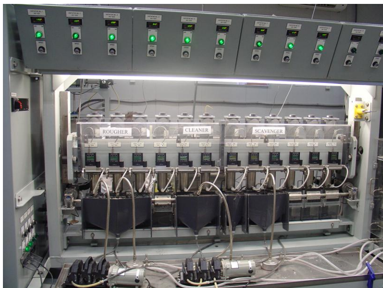
Figura 2 – Mini Planta Piloto de Flotação.
