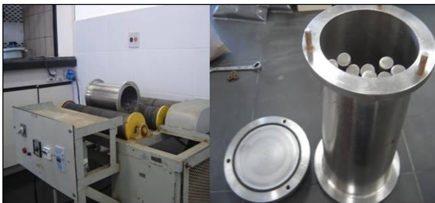
Figura 4 – Unidade motora e moinho de barras padrão
