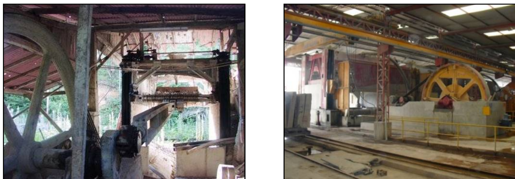
Figura 2. Teares, da década de 50 feito de madeira e movido à água (PMCI, 2009) e multilâminas moderno.
