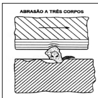
Figura 3. Esquema ilustrando o desgaste lâmina-granalha-rocha (ZUM-GAHR 1987 apud Silveira, 2007).
