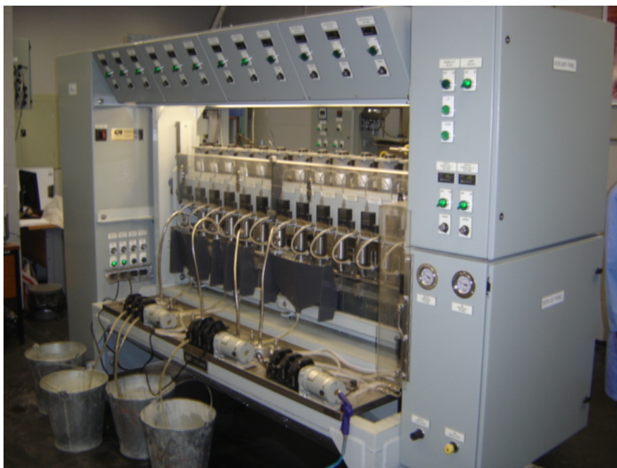
Figura 3. Miniusina de flotação do CETEM.
