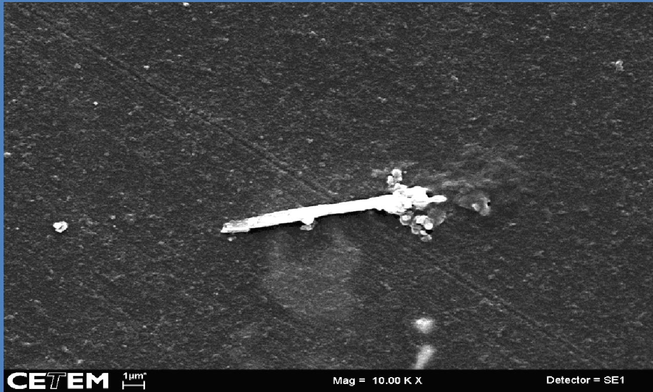
Imagem de particulado de filtros do Dicotômico (PM 2,5) – possível presença de fibra – Microscopia Eletrônica de Varredura
