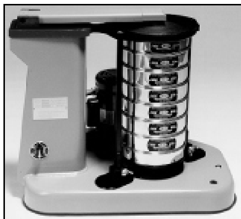
Figura 4 – Peneirador vibratório, do tipo ro-tap , utilizado nos ensaios de resistência à abrasão.
