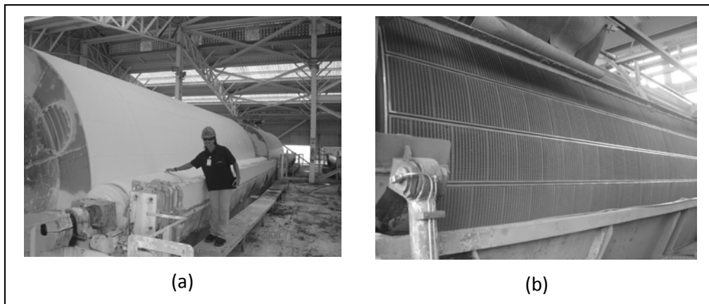
Figura 19 – Unidades industriais de filtração a vácuo: (a) filtro de tambor (indústria de caulim) e (b) seções horizontais de um filtro de tambor (indústria de alumina – lama vermelha)
