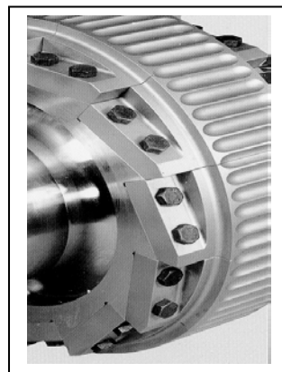
Figura 7 – Rolos segmentados para aplicações de materiais altamente abrasivos (17) .
