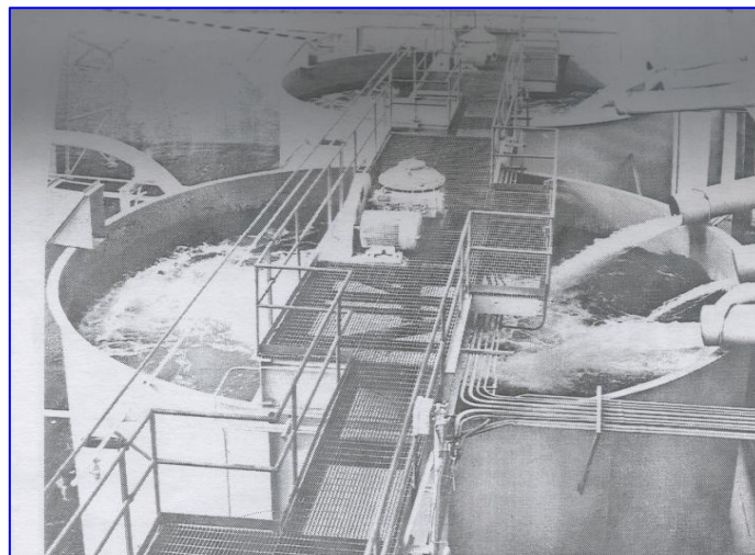
Figura 2. Lixiviação em tanque
