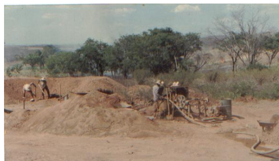
Figura 6 - Lavagem de cascalho para obtenção de rubelita na mina do Condado.
