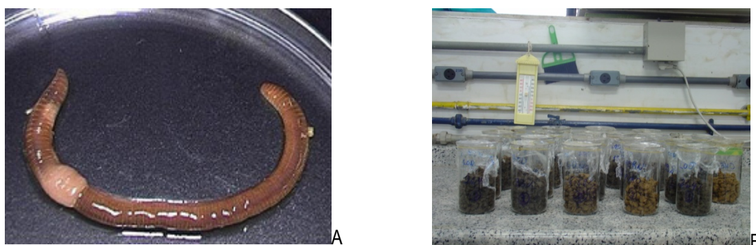
Figura 1. Aspecto de oligoqueta da espécie Eisenia andrei (A); Teste de toxicidade aguda com oligoquetas realizado no Laboratório de Ecotoxicologia do CETEM (B).
