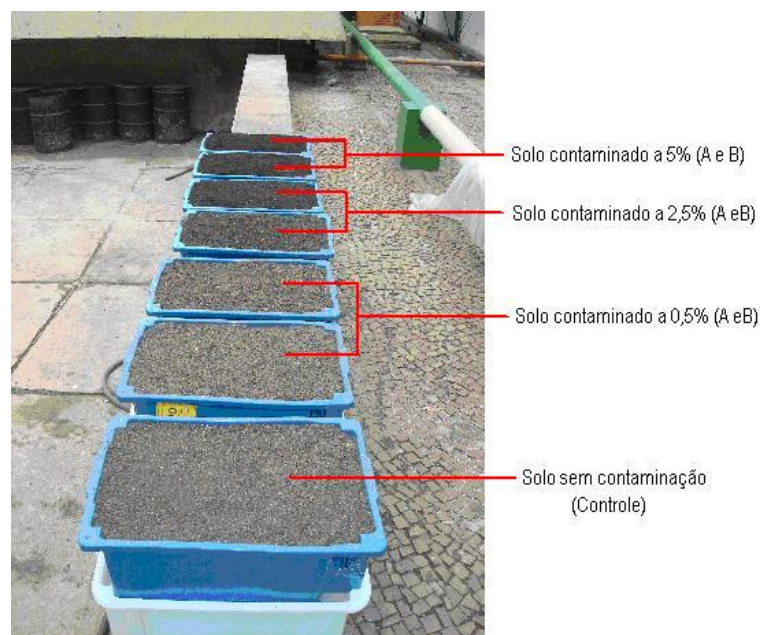
Figura 2: Caixas do sistema 1 contendo solo e suas respectivas concentrações de óleo cru.
