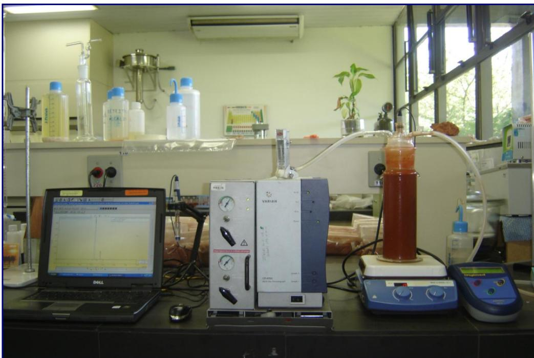
Figura 1. Sistema de absorção gasosa consistindo de reator de vidro, pHmetro, cromatógrafo gasoso e *notebook* com *software* para aquisição de dados.
