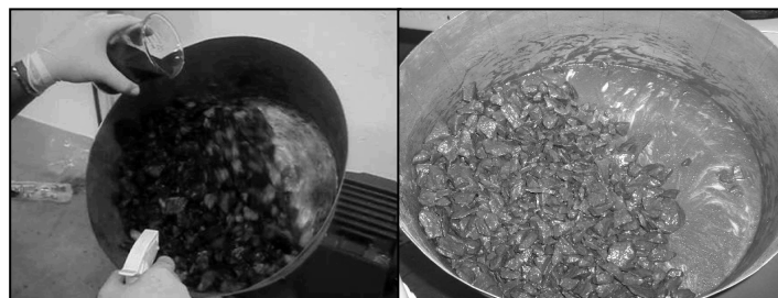
Figura 4. (A) Sistema mecânico de recobrimento; (B) Rocha recoberta com o concentrado de flotação. O recobrimento da rocha suporte com o concentrado de flotação deve ser realizado 24 horas antes de se iniciar as atividades na coluna de biolixiviação, para uma melhor aderência do concentrado de flotação à rocha.
