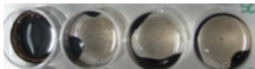
Figura 2 – Teste de degradação em placa de polietileno com 24 cavidades, das amostras F1, F2, F3, F4, F5, SC e SC
