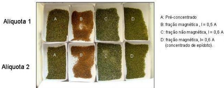
Figura 3. Alimentação e frações resultantes das passagens pelo separador magnético das duas alíquotas.
