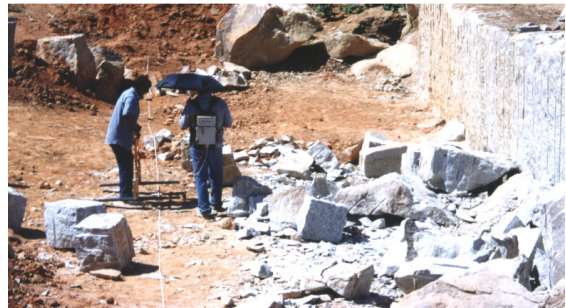
FIGURA 9 - Perfil longitudinal com 74m de comprimento com espaçamento e leitura
