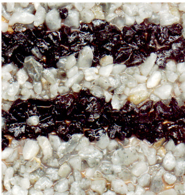
FIGURA 01 – Placas de resina com associação de rejeitos de caulim e outros resíduos minerais
