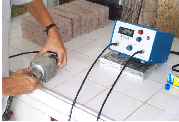
FOTO 1 - Equipamento utilizado para medir a velocidade ultra-sônica das rochas no Laboratório de Caracterização Tecnológica de Rochas Ornamentais do Nutec.
