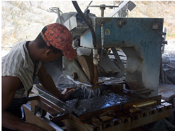
FIGURA 1 – Transformação da laje da rocha ornamental de Santo Antônio de Pádua em lajotas de 47 x 47 x 4 cm.
