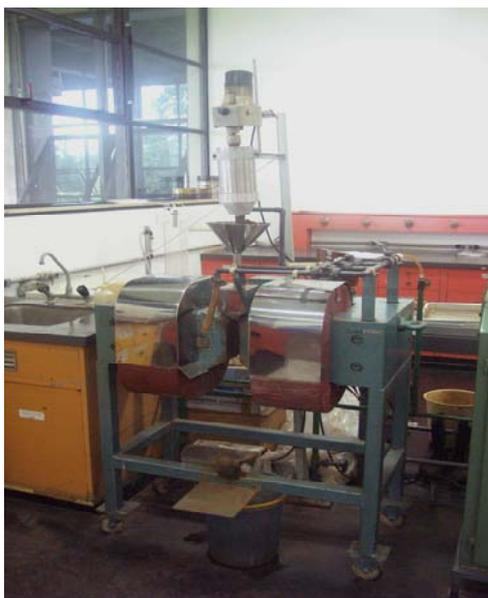
Figura 3. Separador Magnético BOXMAG-RAPID.
