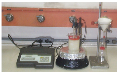
Figura 2 – Aparelhagem utilizada nos ensaios de precipitação
