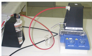
Figura 3 – Aparelhagem utilizada nos ensaios com célula de permeação por agitação utilizando membranas filtrantes
