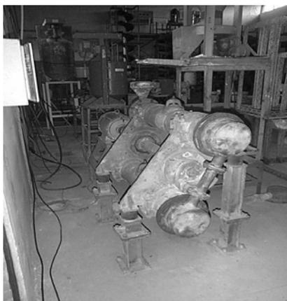
**Figura 1: Moinho cilíndrico de bolas**
