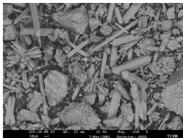
Figura 4 SEM microfotografia do concentrado de xenotima após 1 hora de lixiviação alcalina
