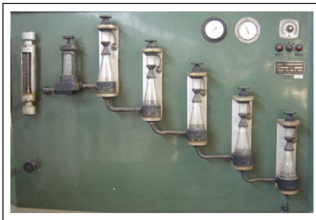
Figura 1 – Cicloclassificador com hidrociclones invertidos em série, existente no CETEM.
