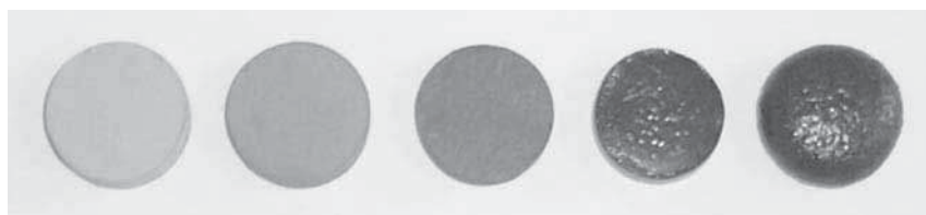
Figura 4: Da esquerda para a direita: amostra a verde, sinterizada aos 1050 °C, 1100 °C, 1150 °C e 1250 °C do pó de granito Rain Forest com granulometria de 200 mesh
