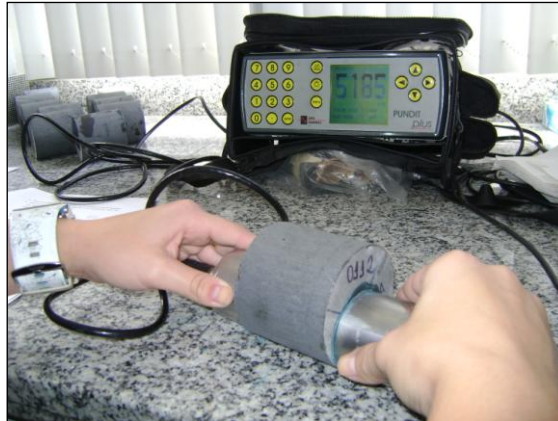
Figura 1. Medição da velocidade e propagação de ondas ultrassônicas.
