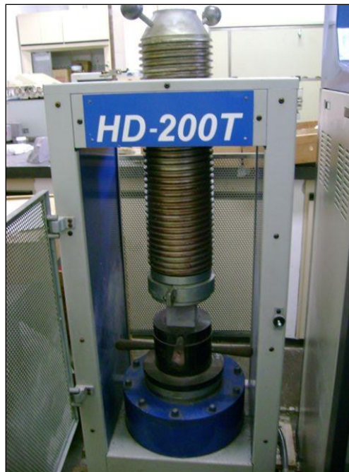
Figura 2. Equipamento utilizado para os ensaios de compressão uniaxial. Laboratório de Rochas Ornamentais/CETEM.
