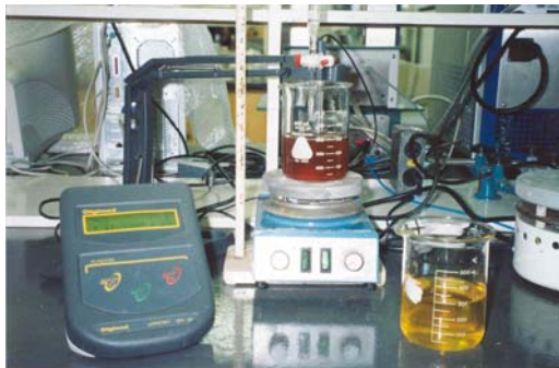
Figura 4– Unidade para ensaios de coagulação/floculação
