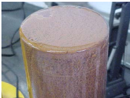
Figura 8 – Espuma do processo de flotação por ar dissolvido
